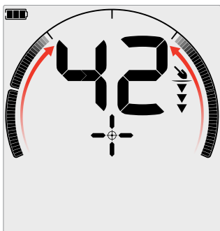
ターゲット信号が弱い/中心がずれている: オンになっている識別セグメントが少ない。ターゲットはコイルの外側に近い位置にあります。
